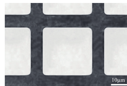
- 形状: テーパレスの四角穴あけ - 材質: セラミック - 穴径: 30 \mu\text{m} \times 30 \mu\text{m} - 深さ: 300 \mu\text{m} (アスペクト比: 1:10) - コーナー半径: < 4 \mu\text{m} - 壁の厚さ: 10 \mu\text{m}
