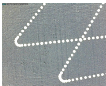
SDC 機能がないときの加工結果 (ガルバノが減速するコーナー部分にパルスが溜まってしまう)
