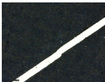
従来システムでの加工結果 (分割したエリアのつなぎ目)
